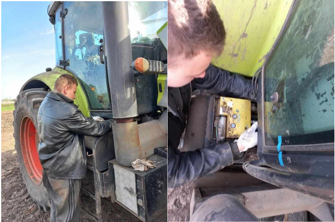
Рис. 17. Отряд «Агроинженер». Демонтаж вошедшего из строя распределителя гидравлической системы трактора AXION в ООО «Терра».
