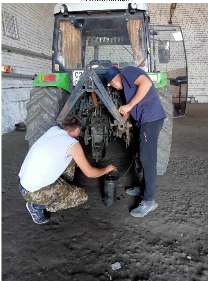
Рис. 12. Отряд «Агроинженер». Бойцы отряда производят техническое обслуживание навесного устройства трактора John Deere перед полевыми работами.
