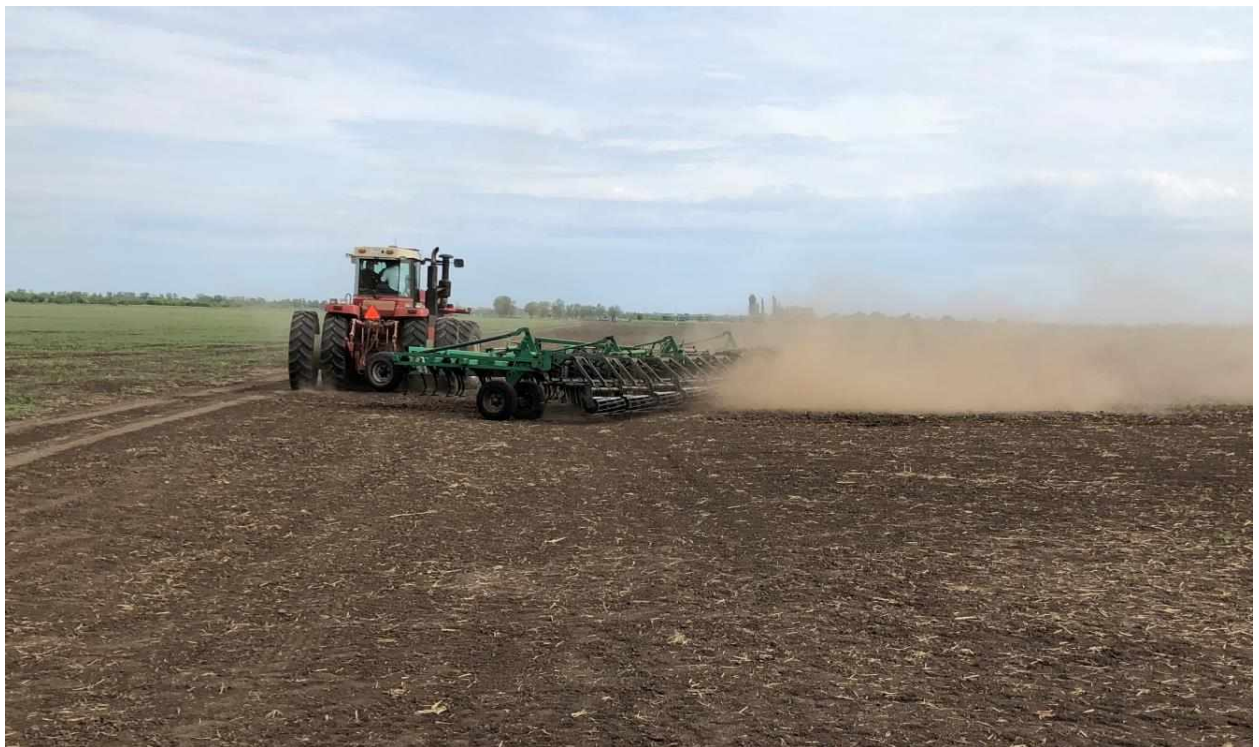
Рис. 18. Отряд «Агроинженер». Культивация паров на тракторе BУHLER VERSATILE 2375 с применением системы автоматического рулевого управления Topcon ACU (Япония)
